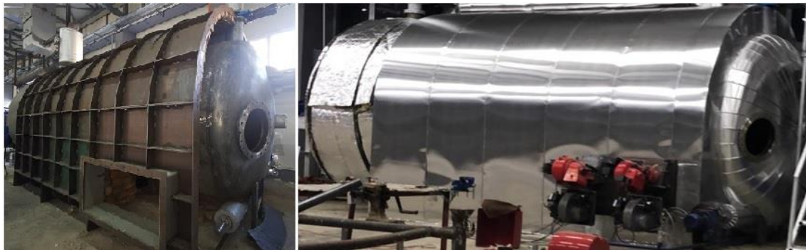
Слика II-10. Изглед на реакторот без и со изолација
