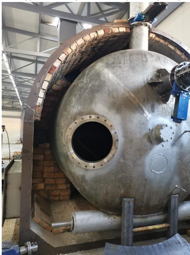
Слика II-16. Комора за согорување со внатрешна изолација и отвор за горилници
