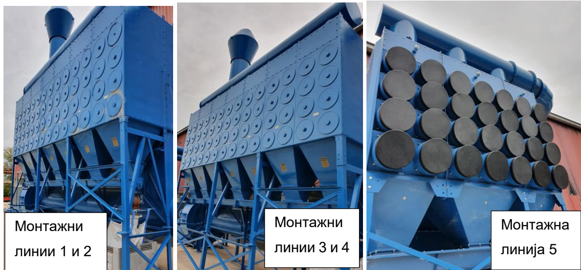
Слика 5 Филтер на монтажни линии 1-5
