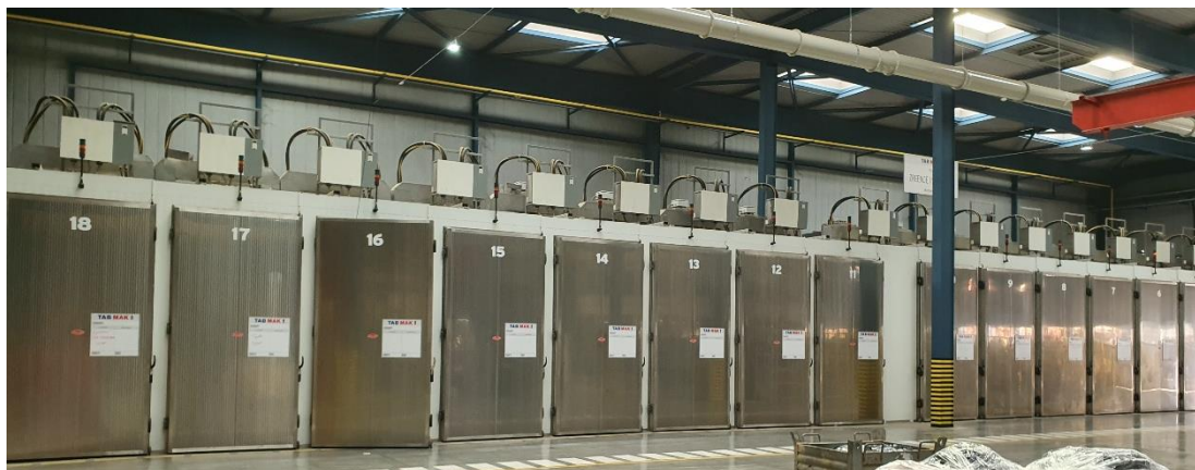
Слика 12 Одделение за зреење и сушење на плочи
