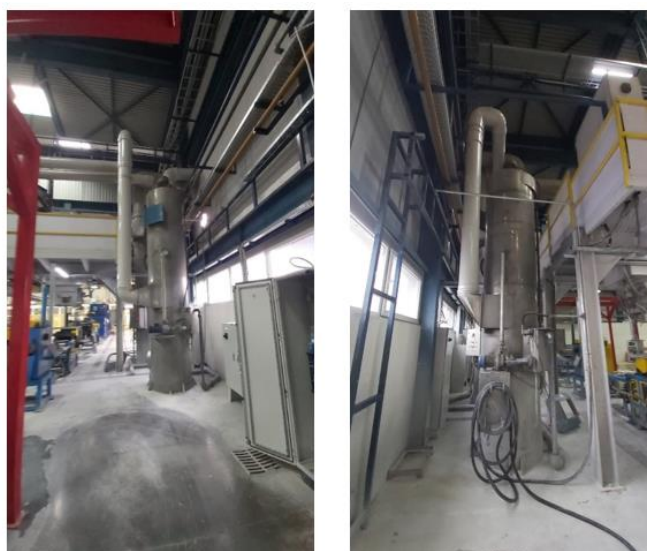
Слика 9 Водни скрубери во процесот на пастирање
