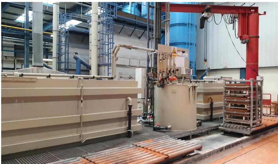
Слика 17 Систем за припрема на електролит и када за сулфатизација на позитивни тракциони плочи
