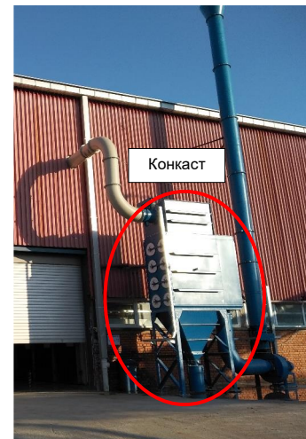
Слика 7 Филтер на машина за производство на мрежа на starter решетки (Concast)
