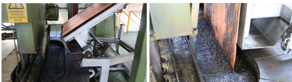
Слика 3 Процес на “хранење” на печка (влез на катоден бакар)
