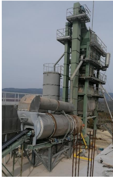
Слика-супара со асфалтна база
