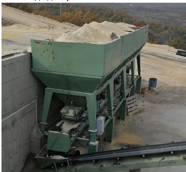
Слика- опрема за дозирање на суровина-варовник
