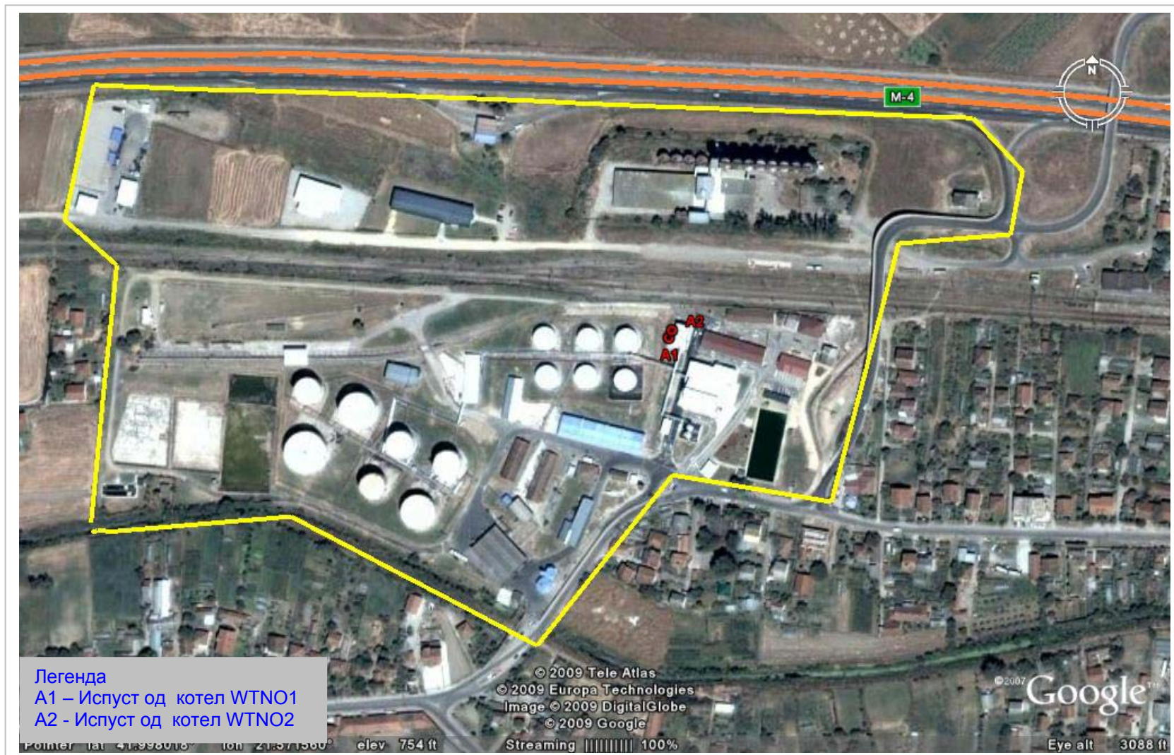
Слика бр. VI.1.1-1: Ситуација на инсталацијата со прикажан распоред на мерните места на емисии во воздух
