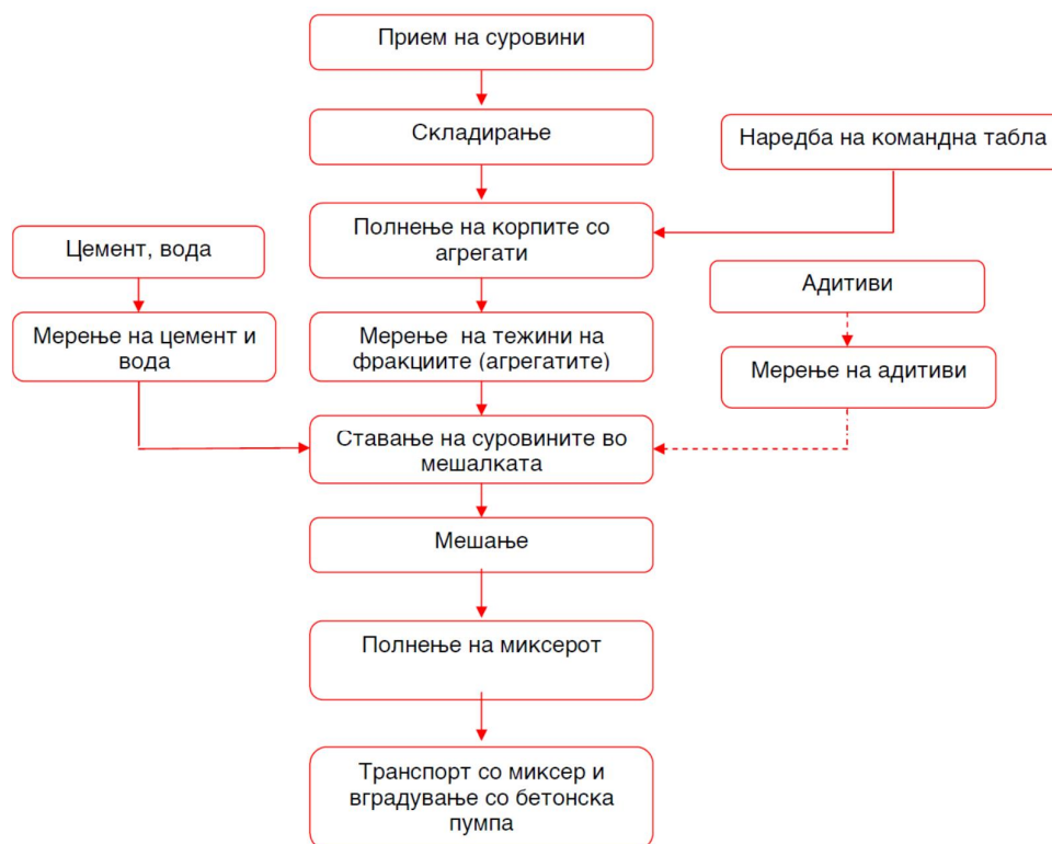
Слика бр.3 Дијаграм на технолошки процес на производство на бетон
