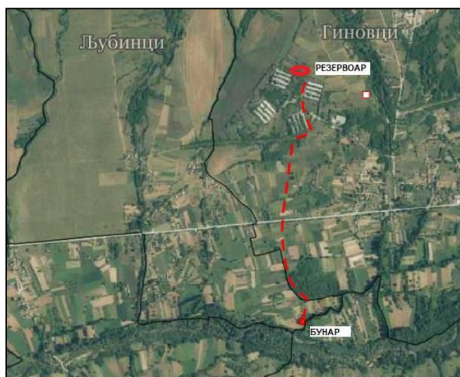
Слика 34 Локација на постоен бунар, потисен цевковод и резервоар за вода одгледувалиште "Гиновци"
