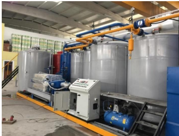
Слика 2 - Постројка за третман на отпадни масла
