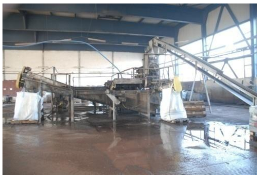
Слика 11: Дробилка за стари акумулатори
