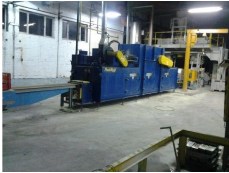
Слика 6: Машина за пастирање Flash Maid
