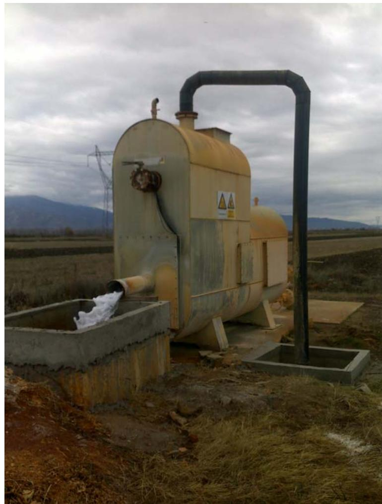
Слика бр.9 Извирање, сепарирање на сиров гас од вода-DZ<sub>2</sub> (Сопственост на ГЕЛИ)
