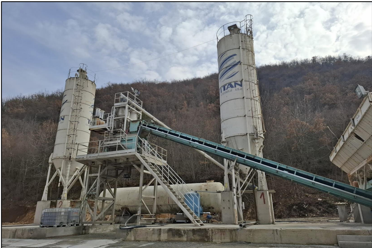
Слика II.2: Бетонска база - PTOLEMEOS 60 - Twin Shaft
