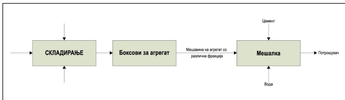
Слика бр. II.6: Шема на технолошки процес во бетонска база
