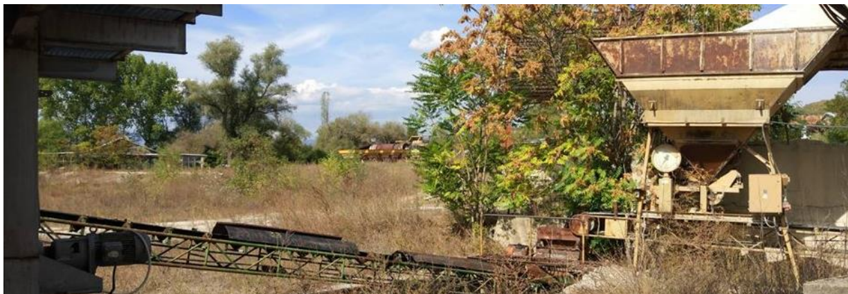
Слика 1. Бункер -дозатор со вага и транспортна лента
