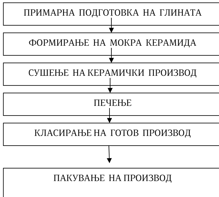
Слика бр. 2 Постапка за добивање керамички производ
