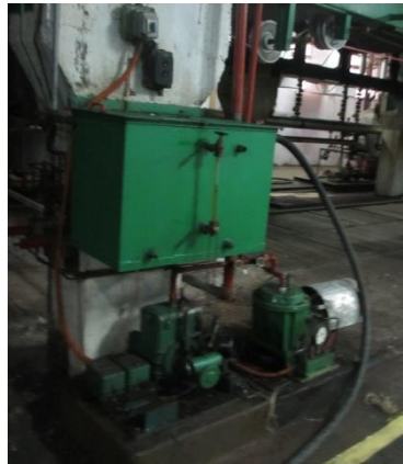
Слика 4 Систем за подмачкување на машината за производство на хартија
