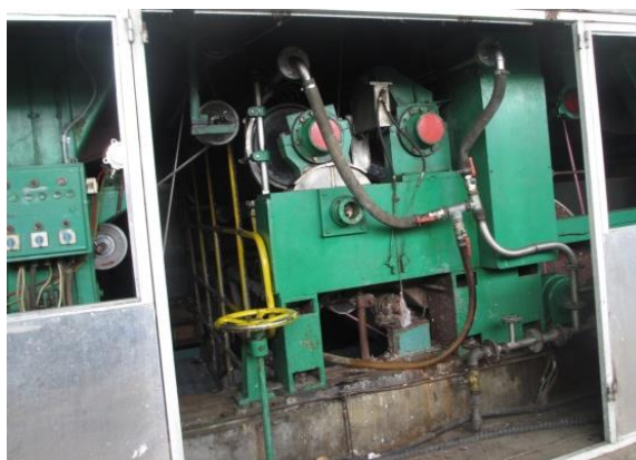
Слика 3 Лајмска преса за дозирање на анјонски скоб
