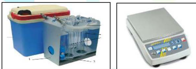
Слика бр. 7.1 и 7.2: Ладилник со систем за собирање на влага и вага
