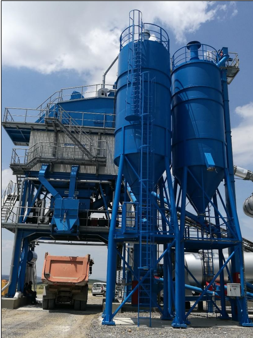
Слика II-18. Силоси за филер со кофичест елеватор и кула за мешање
