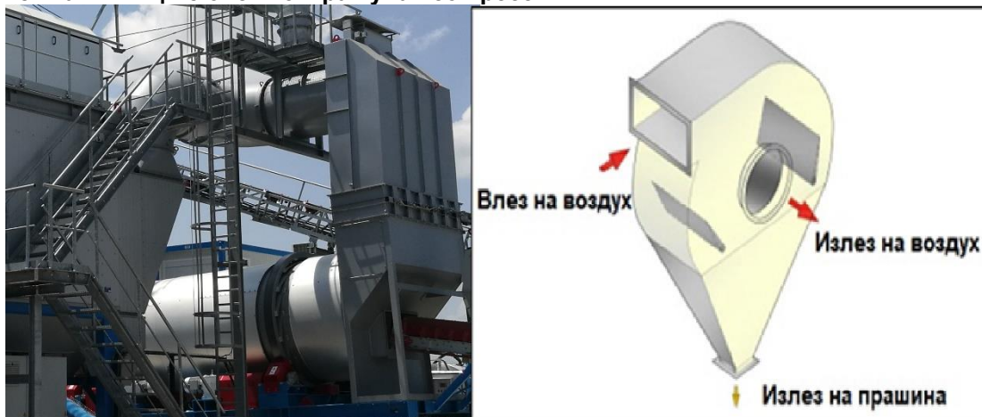
Слика VIII-1. Циклонски отпрашувач со пресек
