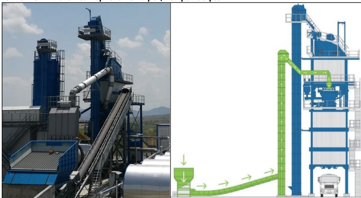
Слика II-31. Систем за користење на рециклиран асфалт.
