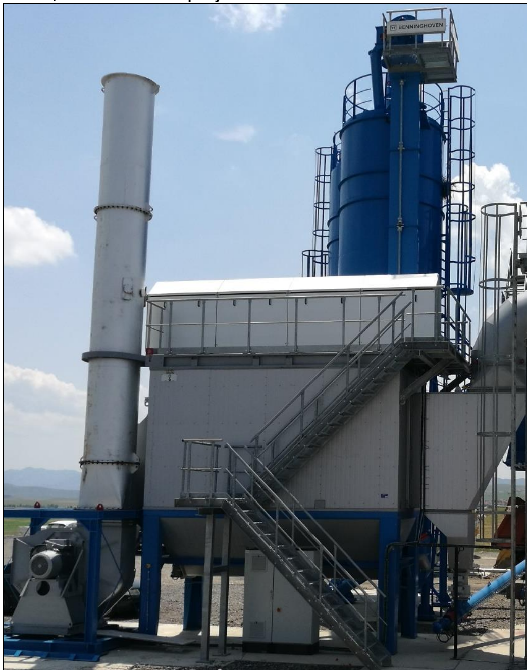
Слика II-17. Оџак со систем за отпрашување
