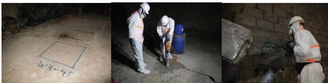
Слика 4.3 Пример за репрезентативен m 2 (лево), земање примерок од јадро (средина) и собирање на бетонски блокови од сид (десно)
