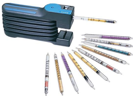
Слика 6.6 Dräger пумпа со мев и епрувети за детекција на гас ( https://www.emssales.net/draeger-accuro-bellows-pump-with-tube-breaker.html )
