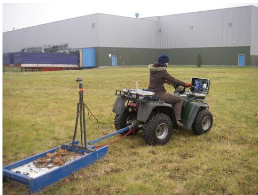
Слика 4.1 Геодетски радар за идентификација на јами со отпад во индустриско подрачје
