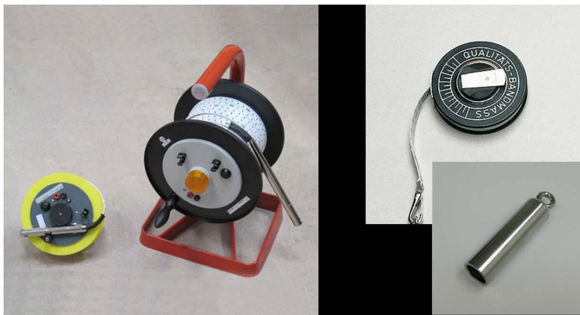
Слика 6.3 Два типа на електронски акустични уреди за ниво на подземна вода (лево); мерна трака со кука и свирче кое дава звук во допир со подземна вода (десно)
