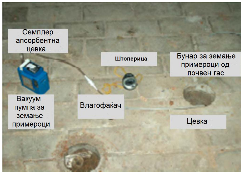
Слика 7.2 Прибор за земање примерок од почвен гас
