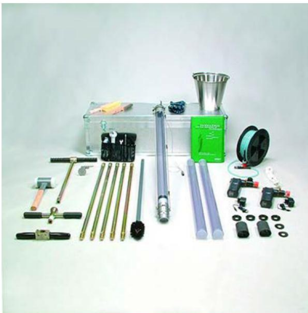
Слика 5.5 Целосен Беекер систем (лево) и систем со зафаќање Van Veen (десно)
