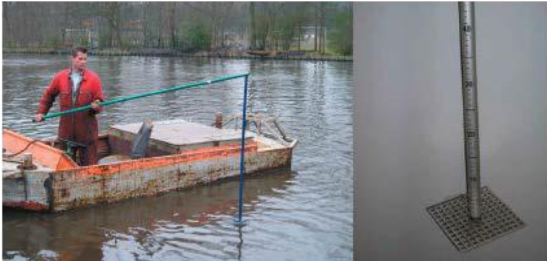
Слика 5.6 Лево: рачно одредување на дебелина на седимент, при што звучната шипка е поврзана со држач, десно: звучна шипка со плоча
