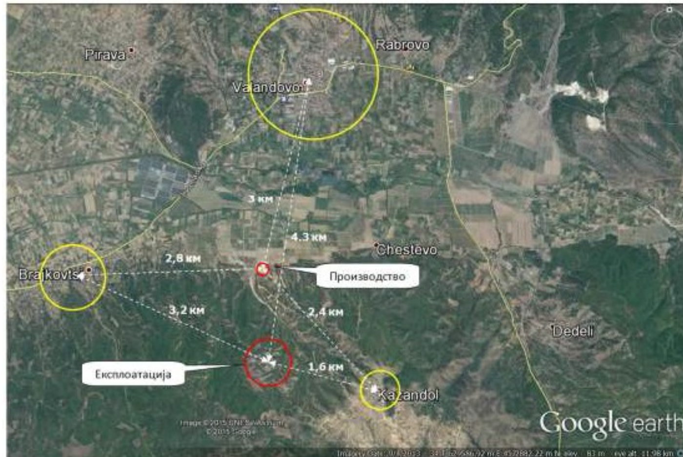
Слика 6-2 – Релативното растојание на осетливи рецептори (населени места во проектното подрачје) од главните извори на оперативна бучава од активностите во предложениот рударски комплекс
