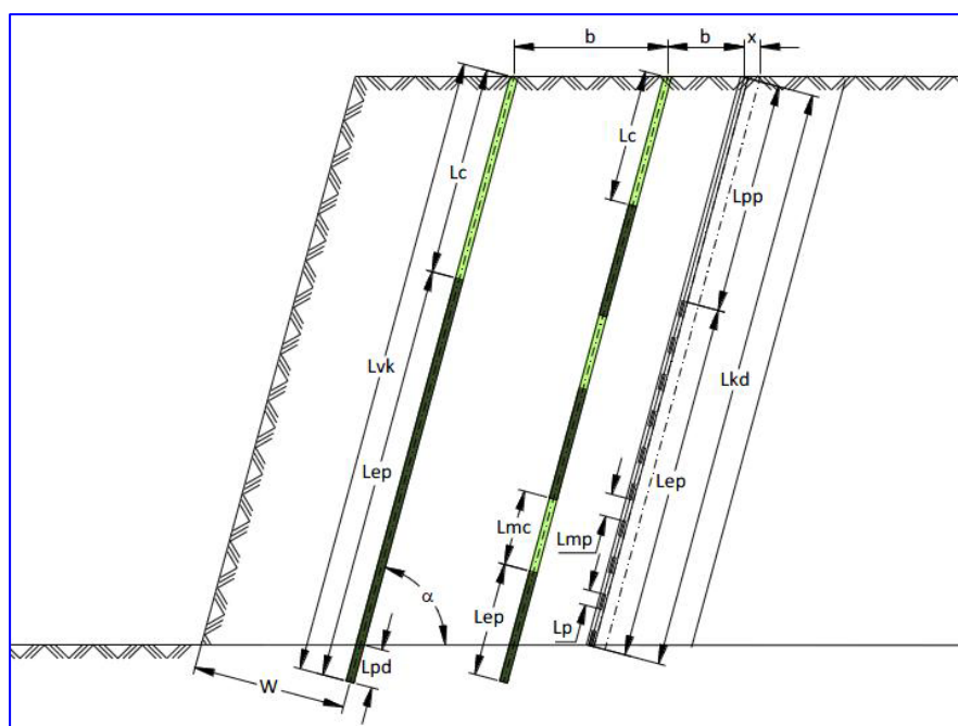
Слика бр.ИИ-6: Дупчечко – минерски параметри при користење на пречници на дупчење од \varnothing 127 mm
