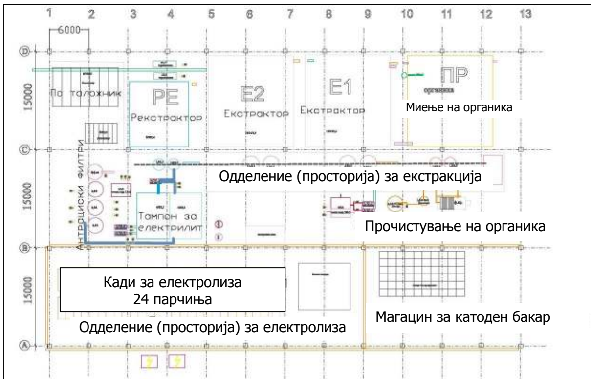
Слика 2-14 – Функционални единици во производствениот погон за катоден бакар
