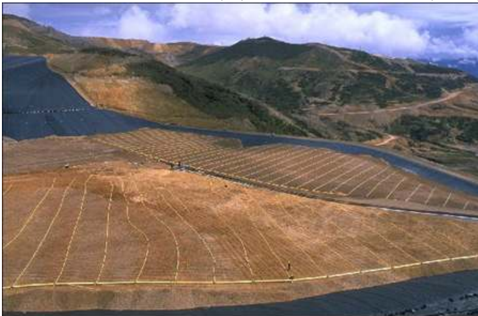
Слика 2-11 – Типичен систем на напрскување на одлагалиште на минерална сировина
