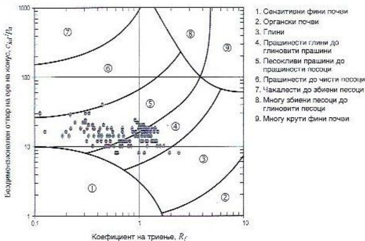
Слика 1. Класификација на материјали според дијаграмот на зависност помеѓу коефициентот на триење R_f и бездимензионалниот отпор на врвот на конусот c_{kd}/p_a (Robertson et al., 1986).
