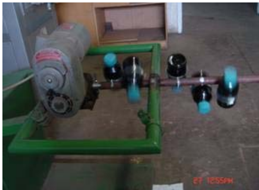
Слика 1: Апаратура “Агитатор” и шише за Личинг
