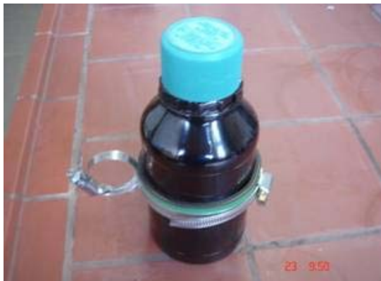
Слика 1: Апаратура “Агитатор” и шише за Личинг
