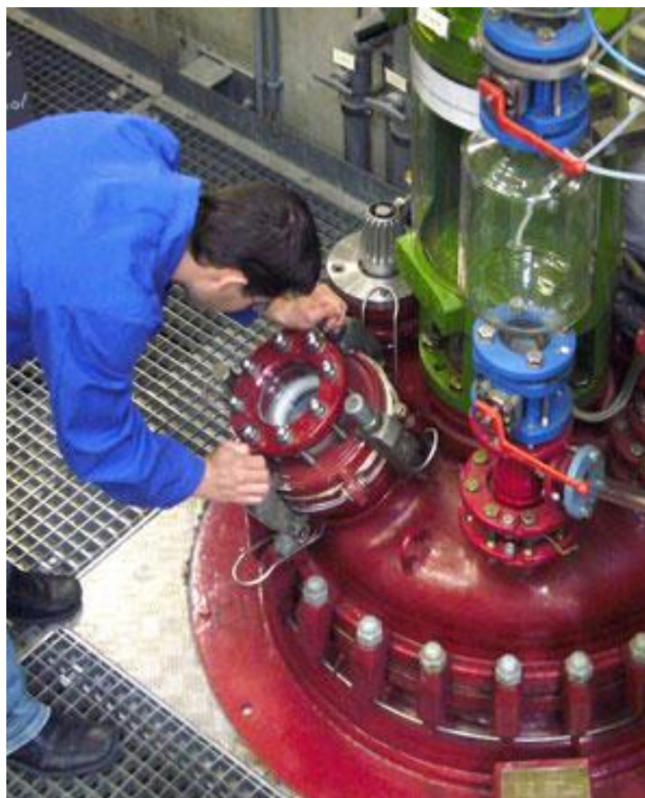
Слика 15: Хемиски отпорен реакторски сад, обложен со стаклен слој, типичен за Фабриката за ПГМ соли.
