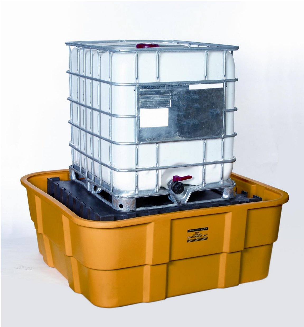
Слика 6: IBC-ња(Контејнери за полу-производи на големо) се користат за транспорт на течни хемикалии и се складираат на посебни палети против истекување, за да се спречи потенцијално отпуштање на содржината.
