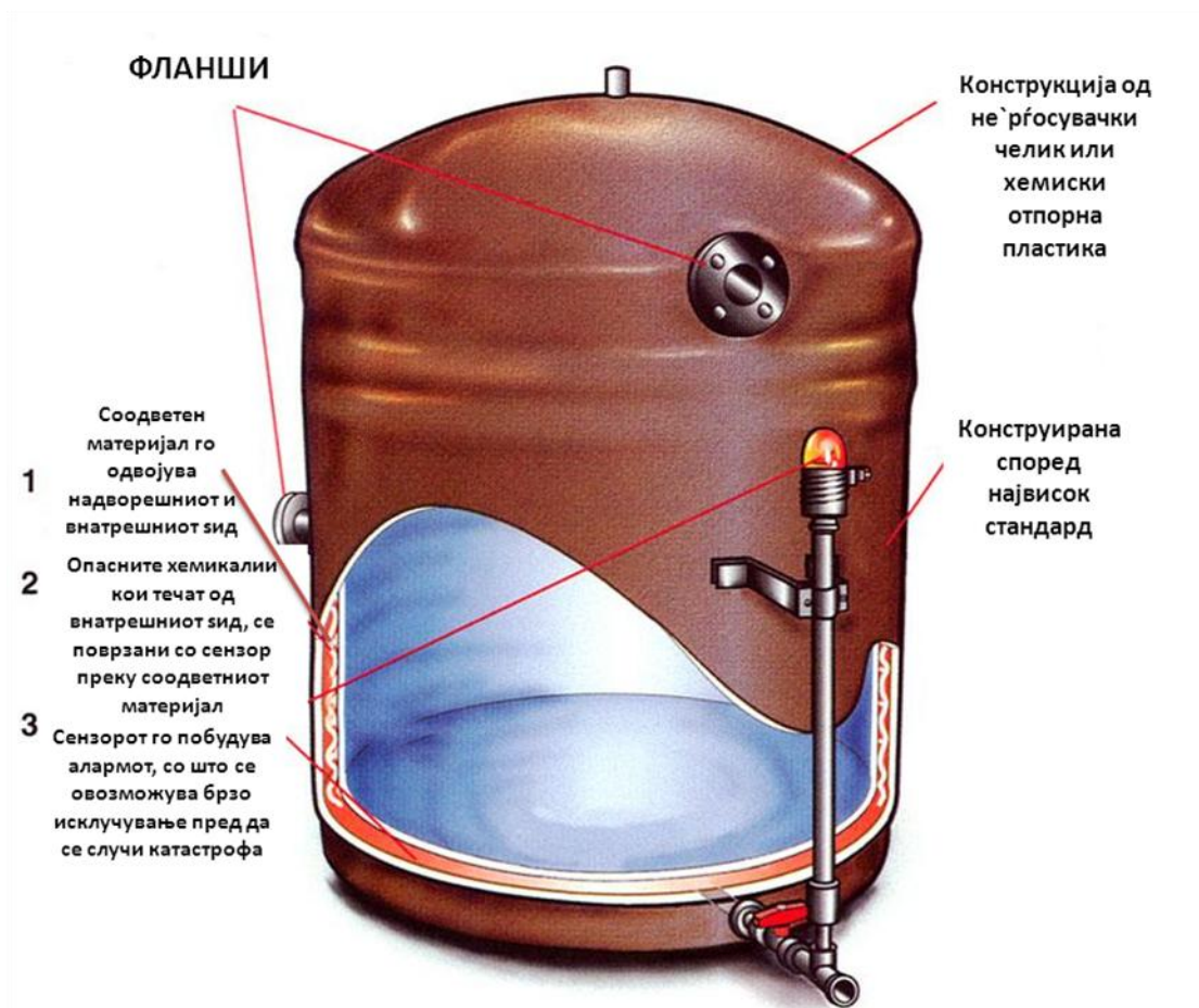
Слика 7: Течните хемикалии се складираани во контејнер со двојни ѕидови за да би се случило случајно испуштање кон животната средина.
