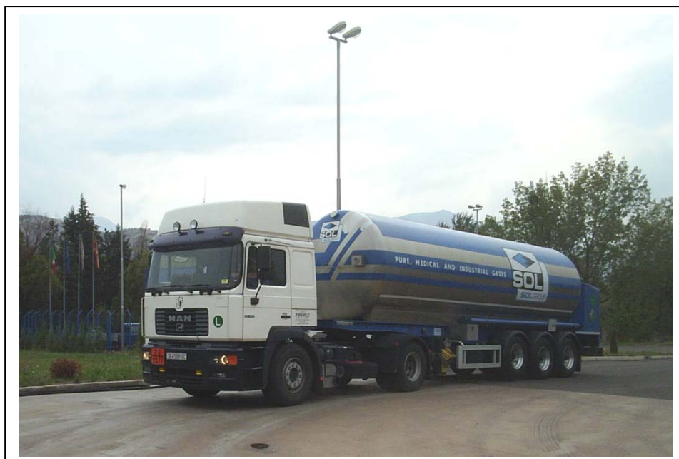
Слика бр. V-9 : Авто цистерна за транспорт на медицински и индустриски гасови
