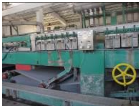
е) формирање на хартиено платно со помош на вакуум, од овој процес водата се рециркулира назад во процесот на подготовка на пулпа
