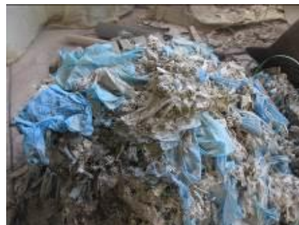
а) хидропулпер б) пречистување на пулпа од песок и примеси в) отпад од примарно прелистување на пулпа
