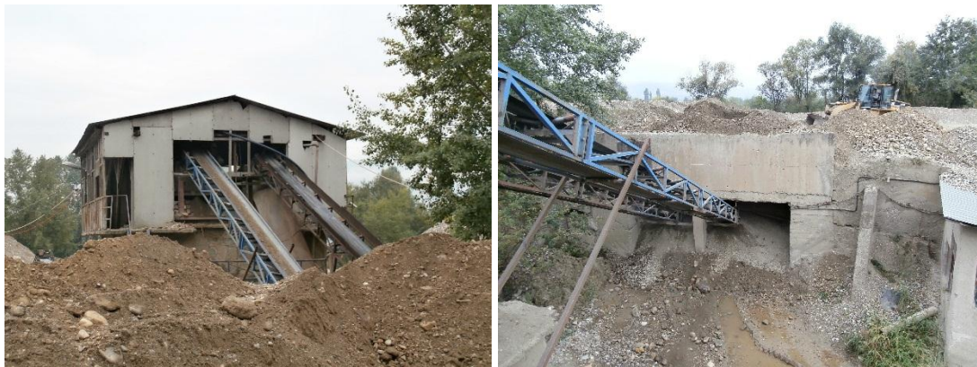
Слика 20 Бункер, левак со вибратор и транспортни ленти за несепариран песок и чакал
