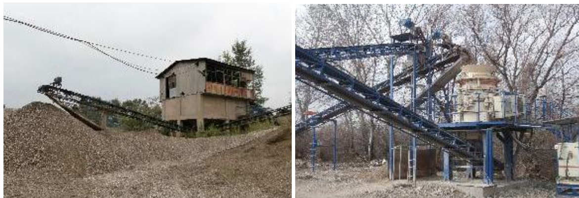
Слика 8 Линија сепарација на песок и линија за дробење (PE Rvi 4000) и сепарација на песок (Metso Aggregates)
