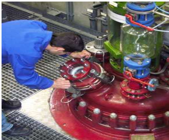
Слика 2.21- Хемиски отпорен реакторски сад, обложен со стаклен слој, типичен за Фабриката за ПГМ соли.
