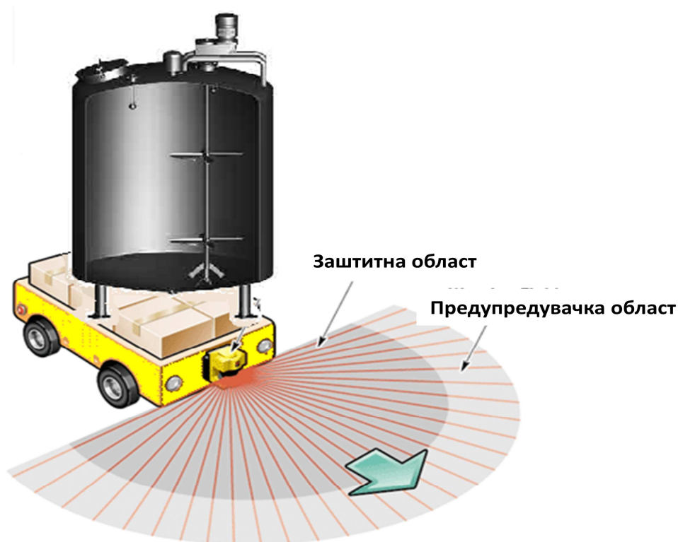
Слика 2.18. Автоматски управувани возила (АУВ) се користат за транспорт на мобилни резервоари кон станици за разни хемиски адитиви во областа за производство на Облога.
