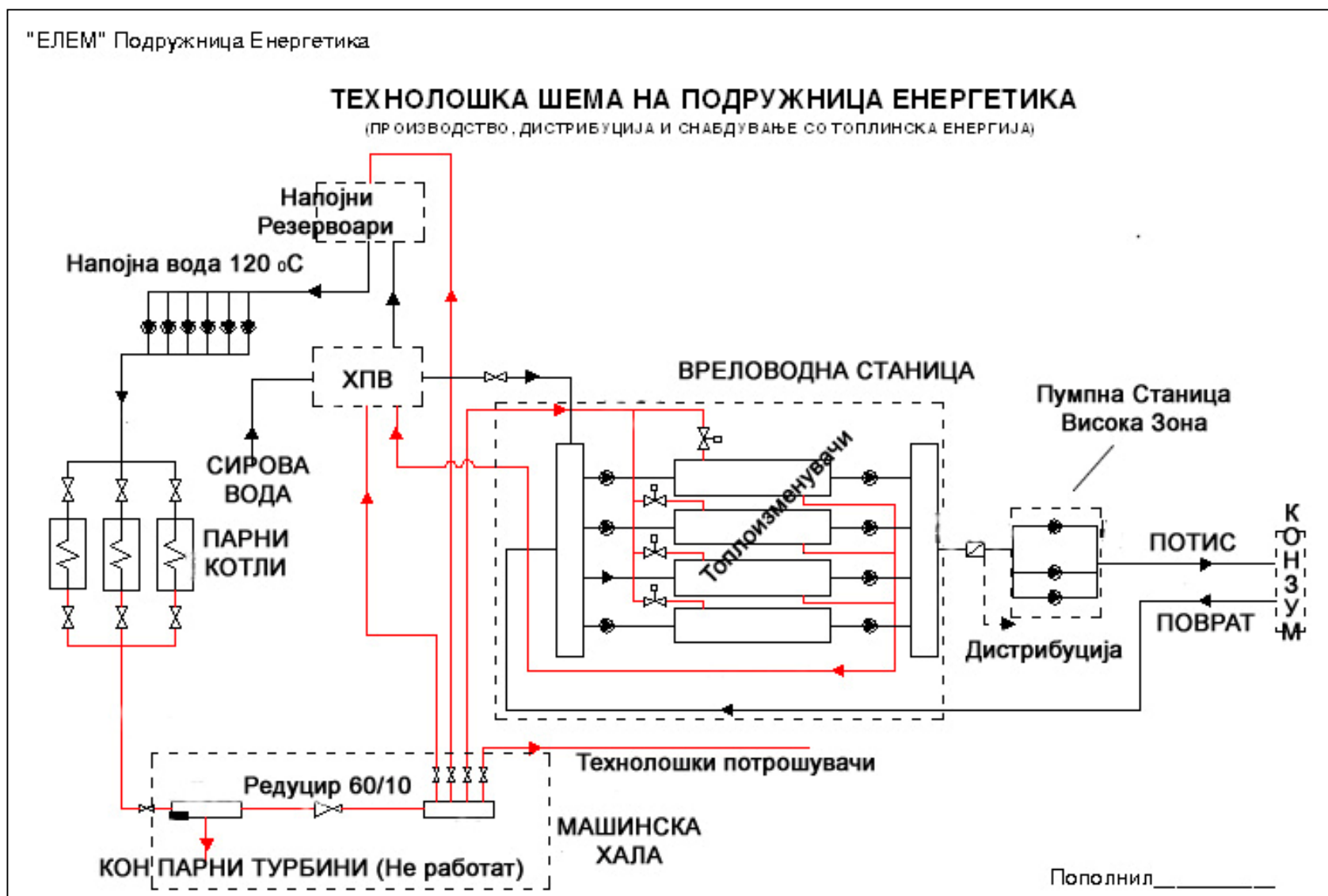
Слика бр. II-8: Технолошка шема за производство, дистрибуција и снабдување со топлинска енергија
