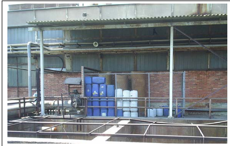
Слика бр. V-4: Складирање на Амонијачна вода и Хидразин хидрат
