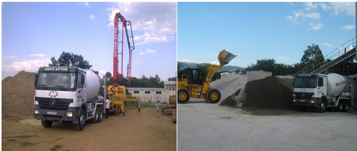
Слика 5 и 6 Помощна механизација и транспортни средства за обавување на потребните активности за производство на готова бетонска смеса
