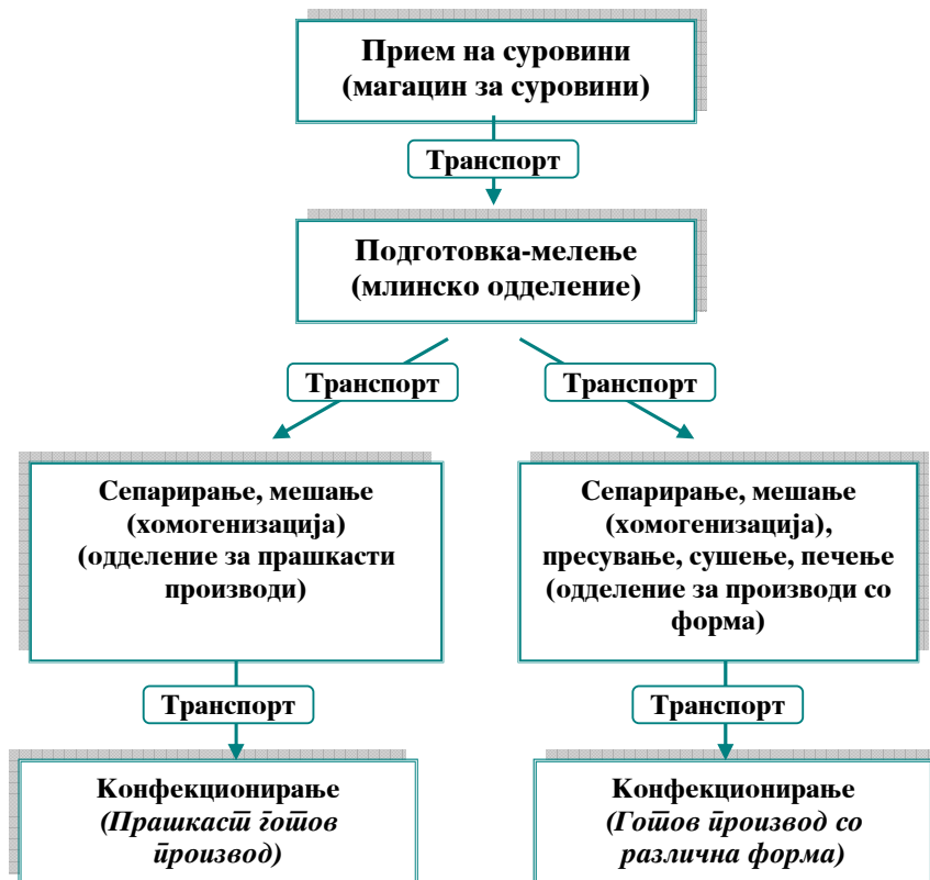
Слика 1: Шематски приказ на технолошкиот процес на производство што се извршува во РИОМК АД "Бомекс Рефрактори", Пехчево
