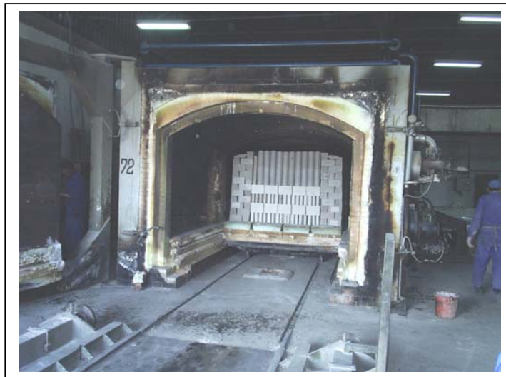
Слика 12: Една од печките за печење на огноотпорни производи
