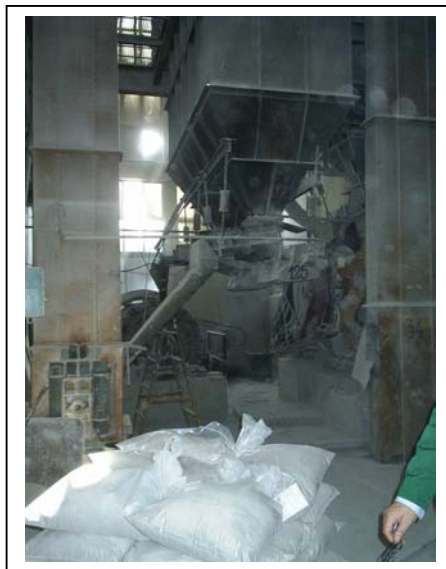
Слика 6: Бункер за гранулар со капацитет од 12 тони во одделот за меѓупроизводи
