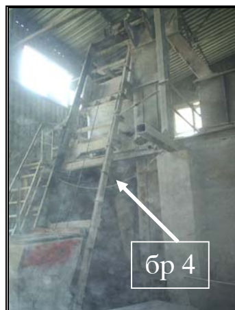
Слика 4: Елеватор со ланци E 315-L во погоној за прашкастии производи
