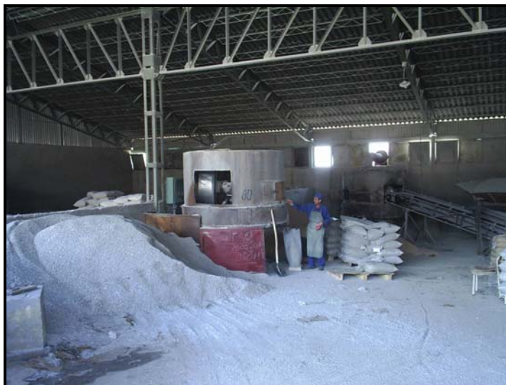
Слика 2: Колен млин сместен во млинското одделение
