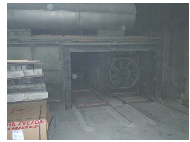
Слика 11: Коморната сушара во одделението за формирани (формовани) производи
