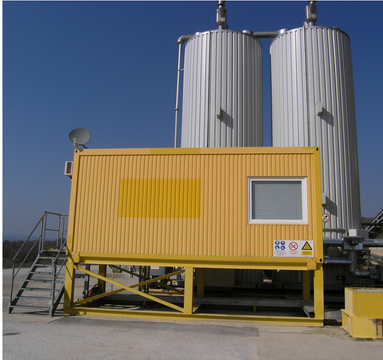
Слика 7. Резервоари за битумен и командна кабина за базата
