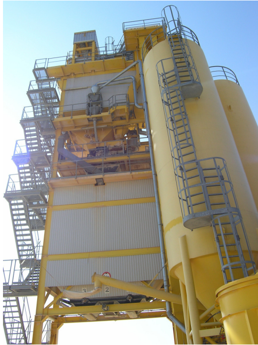
Слика 10. Силоси за филер и резервоар за готов производ
