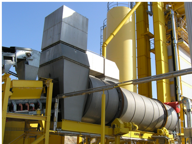
Слика 3. Сушење и прочистување на материјалот
