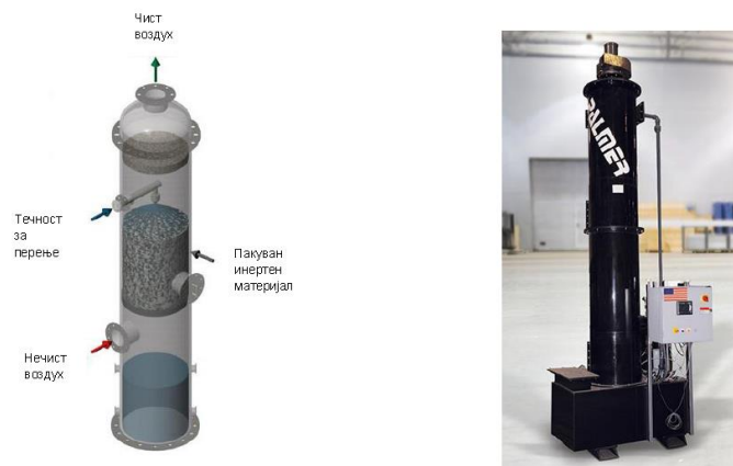
Слика 2-26. Шематски приказ на функционирање и изглед на скрубер (трговските марки се сопственост на други компании и се дадени индикативно)
